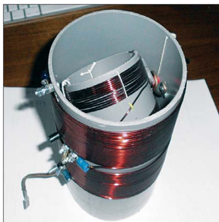
Bild 2: Ladespule mit Variometer auf einem drehbaren Spulenkörper
