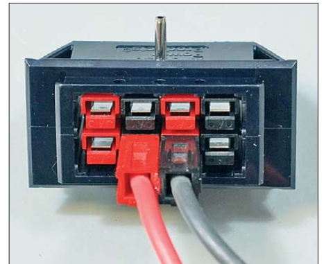
Bild 3: Bei „vorschriftsmäßiger“ Montage im Einbaurahmen (Nut und Feder ineinander rastend) ist höchste Vorsicht angesagt!
