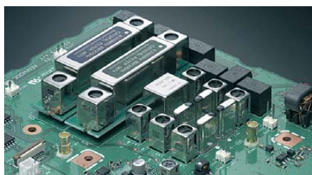
Bild 3: Diese fünf Roofing-Filter des Hauptempfängers sorgen für exzellente Großsignalfestigkeit bis in den unmittelbaren Nahbereich.
