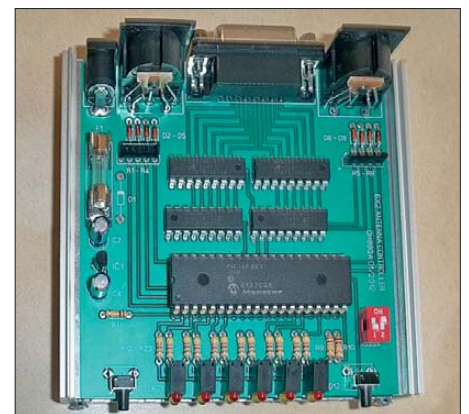
Bild 7: Aufgebaute Prototyp-Platine, eingeschoben in die untere Gehäusehälfte
