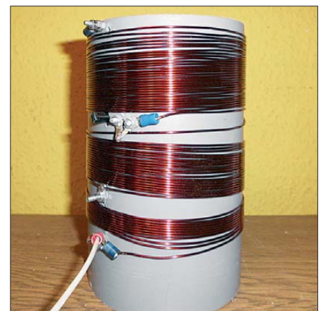
Bild 4: Andere Ausführung der Ladespule mit festen Abgriffen
