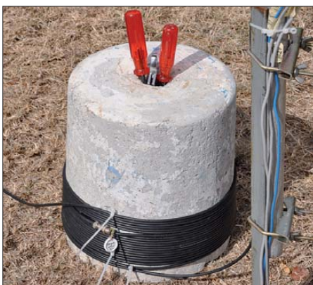
Improvisierte HF-Drossel mittels eines herkömmlichen Betonsockels
