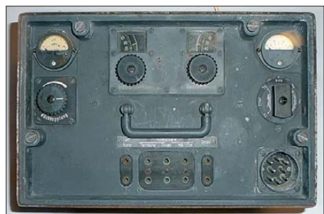
Bild 11: Das Gerät „Elster“ arbeitet auf 500 MHz in FM-Sprechfunk oder tönender Telegrafie.
