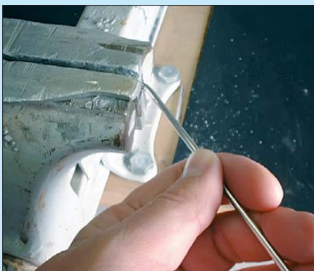
Bild 2: Bearbeitung eines Antennenelements im Schraubstock
