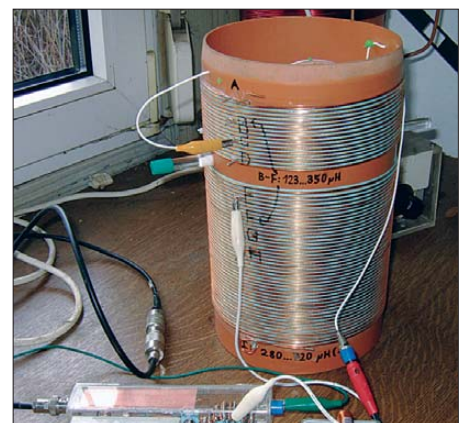
Bild 9: Impedanzanpassung und Kontrollmessung bei DF0WD aus anderer Sicht
