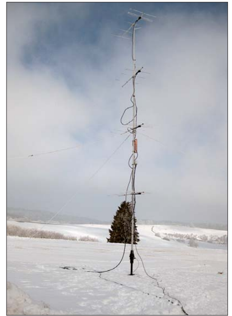
Die 4 x 6-Element-Gruppe von DR5T: Bei einer solchen winterlichen Wetterlage zahlt sich die relative Unempfindlichkeit der DK7ZB-Antennen gegen Vereisung aus.
