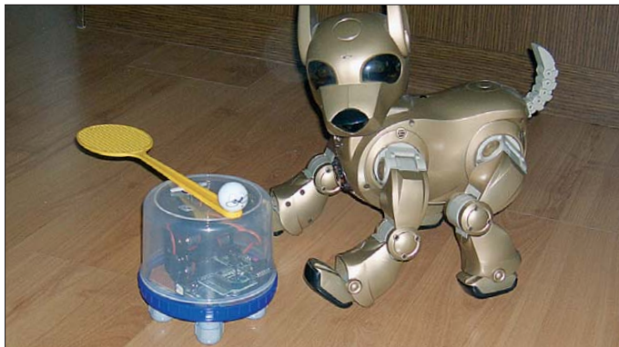
Bild 1: Der Bürstenroboter links lässt sich per Fernbedienung steuern, während der vor einigen Jahren erhältliche, aus gewonnenen Reizen lernende mechanische Hund nach der Anlernphase halbwegs selbstständig reagiert.
