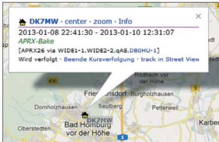
Bild 4: Stationäre APRS-Bake per Funk mit Positionsangabe
