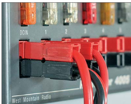
Bild 6: Dicke Transceiverkabel bedeuten bereits eine nennenswerte Last für die Powerpole-Verbinder. Ausreichende Zugentlastung ist daher unumgänglich. Fotos: Red. FA
