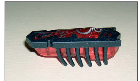
Bild 2: Die Form der Borsten und ihre ungleichmäßigen Knickwinkel bestimmen bei diesem, durch einen Vibrationsmotor angetriebenen Roboter die Laufrichtung.
