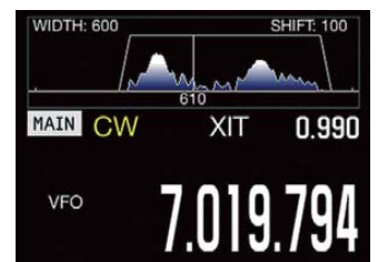
Bild 6 (unten links): So sieht die Anzeige der Geräteparameter normalerweise aus. Hier dient der untere Teil zur Grundkonfiguration der drei Empfangsfilter.
