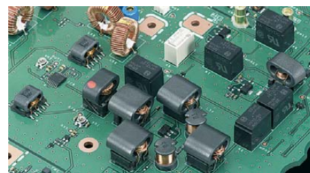
Bild 4: 1. Mischer (links) und die induktiv gekoppelten Vorverstärker des Hauptempfängers; die großen Kerne vermeiden IM durch magnetische Sättigungserscheinungen.
