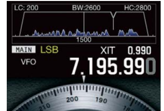
Bilder 5: Das Hauptdisplay mit dem Grundmenü; die Anzeige der Geräteparameter wird bei Platzmangel minimiert.
