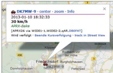
Bild 5: Mobile APRS-Tracker-Bake über Funk mit aktueller Position
