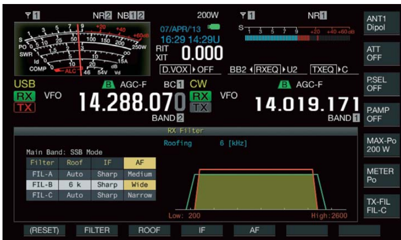
Bilder 7 bis 10 (rechts): Die vier Standard-Ansichten beim Zweitisdisplay, oben mit der nachempfundenen Analogskale, darunter stattdessen mit der digitalen Frequenzanzeige. Diese lässt sich durch die beider Empfangsteile inklusive Frequenzdifferenz ersetzen. Die vierte Version verzichtet auf die sehr nützliche schematische Filterdarstellung, die passgerecht durch das Audio-Scope unterlegt wird: oben SSB mit Notch, darunter zwei CW-Signale, dann ein einzelnes (nach diesem Bild kann man sich recht genau Einpfeifen).
