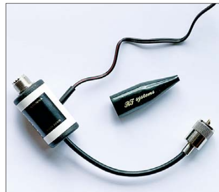
Bild 2: Die mitgelieferte Fernspeiseweiche zur Stromversorgung der Antenne übers Koaxialkabel ist in zwei Varianten erhältlich, hier mit fest angebautem Kabel des 230-V-Steckernetzteils. Das kurze Kabel im Bild führt zum Antenneneingang am Empfänger. Zum Lieferumfang gehören Kabelbinder zur Zugentlastung sowie fürs Antennenkabel ein PL259-Antennenstecker samt Wetterschutz.
