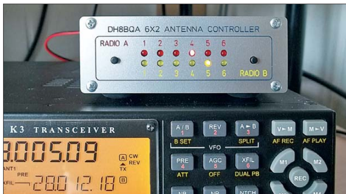
Bild 1: Steuergerät für den 6 × 2-Antennenschalter während des Funkbetriebs; der Elecraft K3 ist Radio B, während der Kenwood TS-590 als Radio A mit eigenem Steuergerät im anderen Shack steht.
