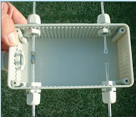
Bild 1: Verbindung der zwei Reflektor-Abschnitte mittels Lüsterklemme (links)
