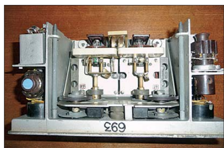
Bild 12: Elster von innen; das Gerät mit Pendelempfänger und einstufigem Sender hatte eine Ausgangsleistung um 150 mW
