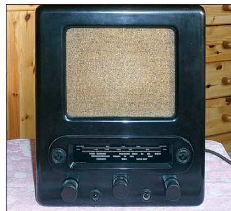
Bild 4: Volksempfänger VE 301 dyn mit dynamischem Lautsprecher und horizontaler Glasskala mit Sendernamen
