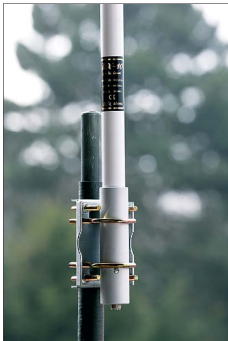
Bild 1: Das Antennenelement der DX-10 sollte man möglichst außerhalb des häuslichen elektrischen Störpegels montieren. Am Fußpunkt ist die offen liegende Antennenbuchse, von wo aus ein bis zu 50 m langes Koaxialkabel zur Fernspeiseweiche führt, sichtbar.
