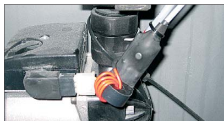
Bild 2: Sollen kleinere Wechselströme gemessen werden, ist der Leiter mehrmals durch das Innere des Sensors zu führen. Der Sekundärstrom erhöht sich dadurch proportional. Fotos: DG9BFJ
