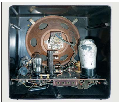
Bild 2: Im DKE 38 steckten die Röhren VCL 11 und VY 2.
