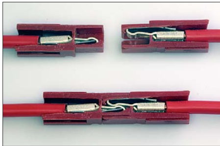
Bild 1: Zwei aufgefärbte Steckverbinder in Seitenansicht – oben vor, unten nach dem Zusammenstecken; deutlich sind Kontaktstifte und Steckergehäuse zu erkennen.
