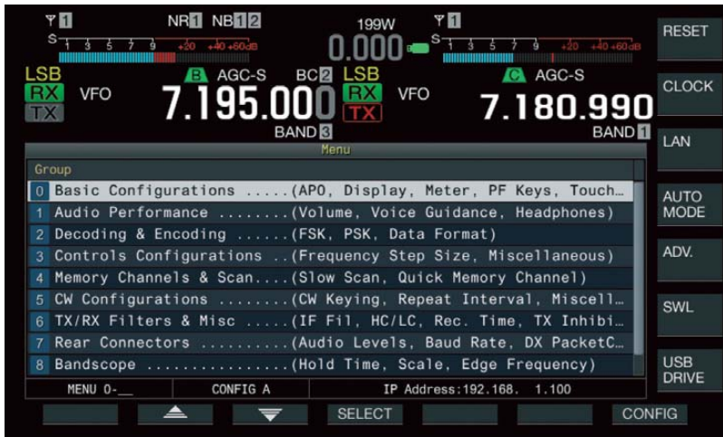
Bilder 5: Das Hauptdisplay mit dem Grundmenü; die Anzeige der Geräteparameter wird bei Platzmangel minimiert.
