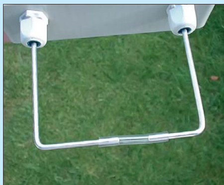
Bild 6: Schlauchstücke stellen die mechanische Verbindung zwischen den äußeren Enden der Elemente her. Dadurch wird auch beim Transport der korrekte Abstand gewahrt.
