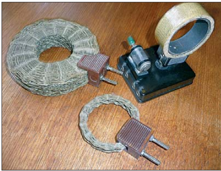
Bild 6: Ein solcher Detektor-Empfänger mit mehreren Wechselfspulen ersetzte nach Kriegsende zunächst das Röhrenradio.
