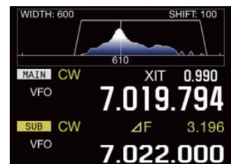
Bilder 7 bis 10 (rechts): Die vier Standard-Ansichten beim Zweitisdisplay, oben mit der nachempfundenen Analogskale, darunter stattdessen mit der digitalen Frequenzanzeige. Diese lässt sich durch die beider Empfangsteile inklusive Frequenzdifferenz ersetzen. Die vierte Version verzichtet auf die sehr nützliche schematische Filterdarstellung, die passgerecht durch das Audio-Scope unterlegt wird: oben SSB mit Notch, darunter zwei CW-Signale, dann ein einzelnes (nach diesem Bild kann man sich recht genau Einpfeifen).
