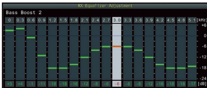
Bild 13: Das Untermenü für die Einstellung des Empfangs-Equalizers Bass Boost 2; der Pegel des weißen Kanals lässt sich nun mit Multi/Ch verändern. Einen gleichartigen Equalizer gibt beim Sender.
